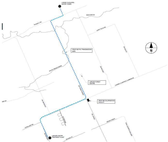
La majorité de la construction sera réalisée à l'aide de méthodes HDD ce qui signifie que le tuyau est foré horizontalement sous la surface et non excavé à ciel ouvert. Cela réduit considérablement l'impact sur toutes les infrastructures existantes et la propriété privée. Tous les travaux proposés seront exécutés dans les emprises municipales et non sur une propriété privée. Aucun branchement ne sera effectué le long du tracé, car cette conduite n'est qu'une conduite principale de transmission.
