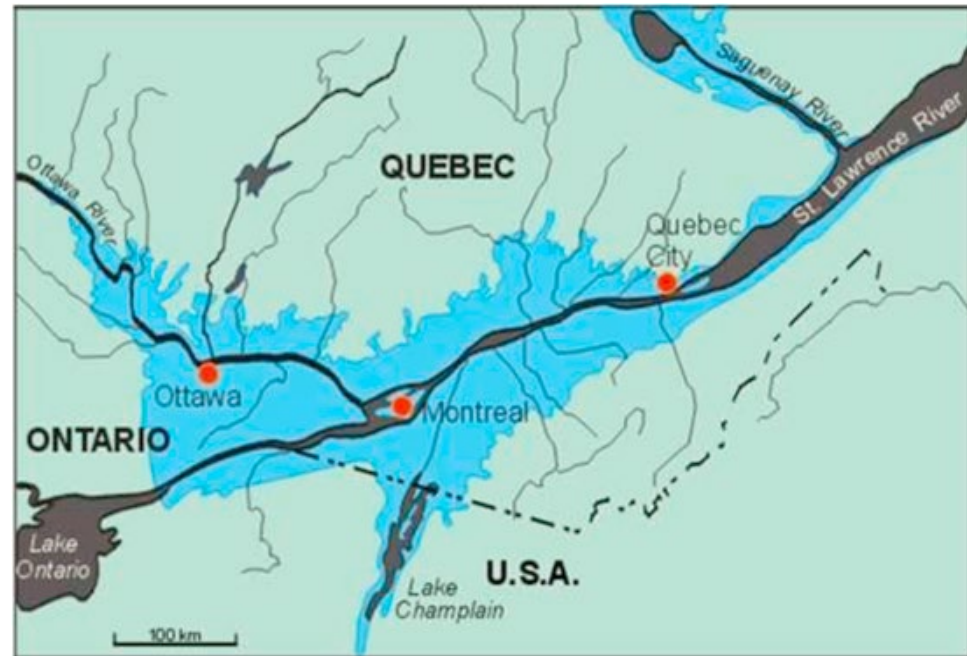
Étendue approximative des sédiments de la mer de Champlain dans l'Est de l'Ontario et l'Ouest du Québec (Soil Dynamics and Earthquake Engineering, 2020).
